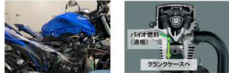
実車試験による、バイオアルコール使用時の冷機時の始動性、燃焼安定性、エンジン潤滑油希釈等のメカニズム説明
